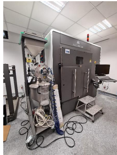
k) Laborator Tehnici inovative. Imprimantă 3D cu pulberi metalice;
