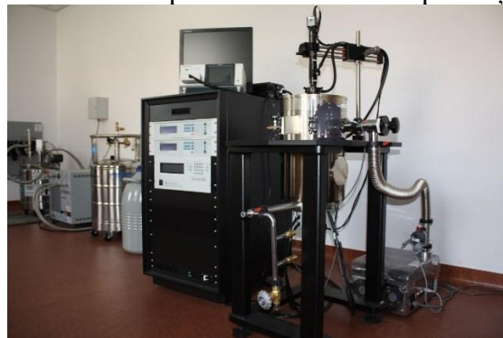
Stație criogenică cu braț de manipulare pentru testarea nondistructivă a materialelor și echipamentelor în câmp electromagnetic inclusiv set probe și accesorii
