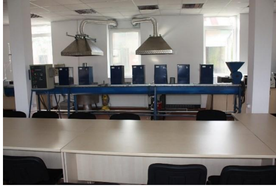
Echipament industrial pentru tratarea și decontaminarea produselor granulare în câmp de microunde
