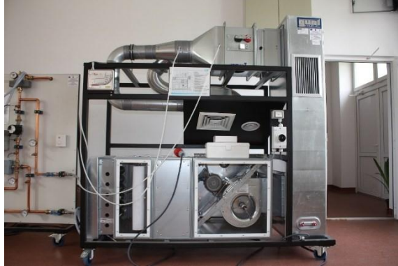
Stand de cercetare – Sistem de ventilație și unitate de control auxiliară
