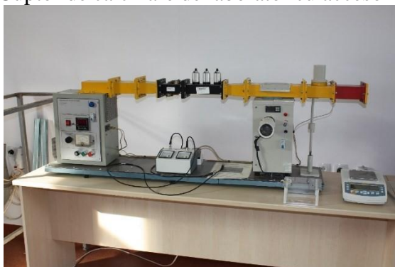
Echipament de laborator pentru tratarea și decontaminarea produselor granulare în câmp de microunde
