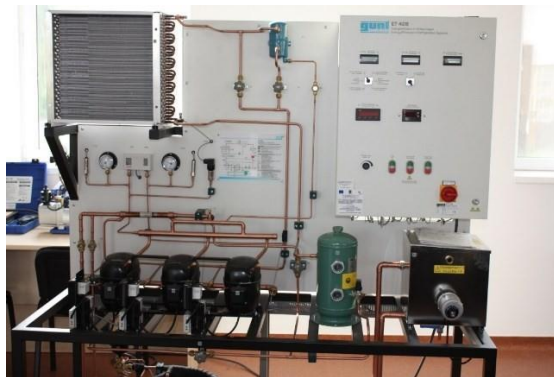
Stand de cercetare pentru determinarea eficienței frigorifice în sistemele de refrigerare
