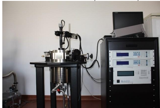
Stație criogenică cu braț de manipulare pentru testarea nondistructivă a materialelor și echipamentelor în câmp electric inclusiv set probe și accesorii
