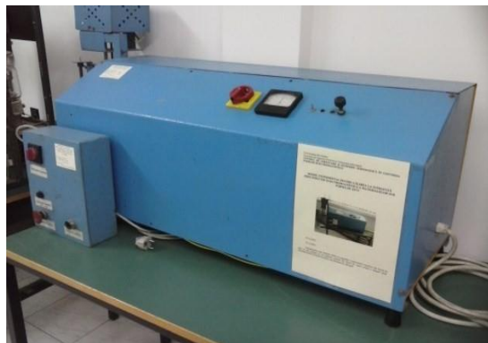
Stand de cercetare pentru călirea la suprafață prin inducție electromagnetică a materialelor sub formă de țevi
