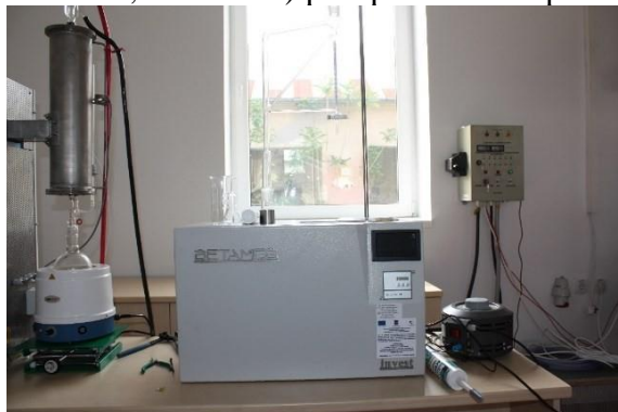
Reactor de laborator în câmp de microunde în vederea obținerii materialelor hibride (polimeri conductori, semiconductori, dielectrics) prin procedee de piroliză prin pulverizare
