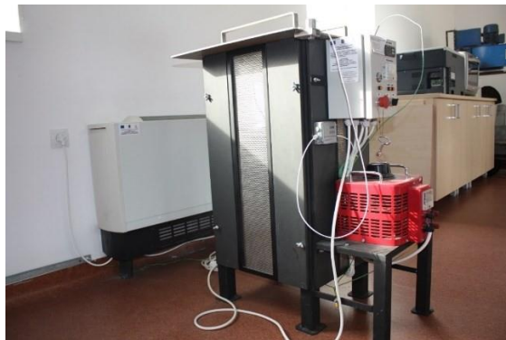
Stand de cercetare cu microunde și echipamente de măsură și control pentru studiul materialelor ceramice susceptoare
