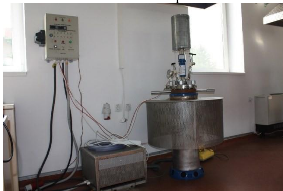
Reactor de laborator în câmp de microunde în vederea obținerii materialelor hibride (polimeri conductori, semiconductori, dielectrics) prin procedee de piroliză prin pulverizare
