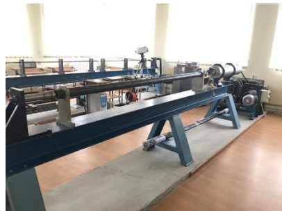
e) Laboratorul de testare-evaluare a caracteristicilor mecanice ale materialelor în regim dinamic;
