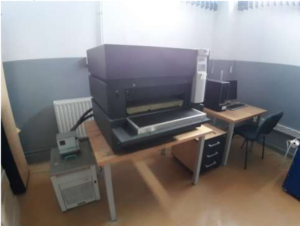
Mașină pentru determinarea conductivității și rezistenței termice HFM Lambda
