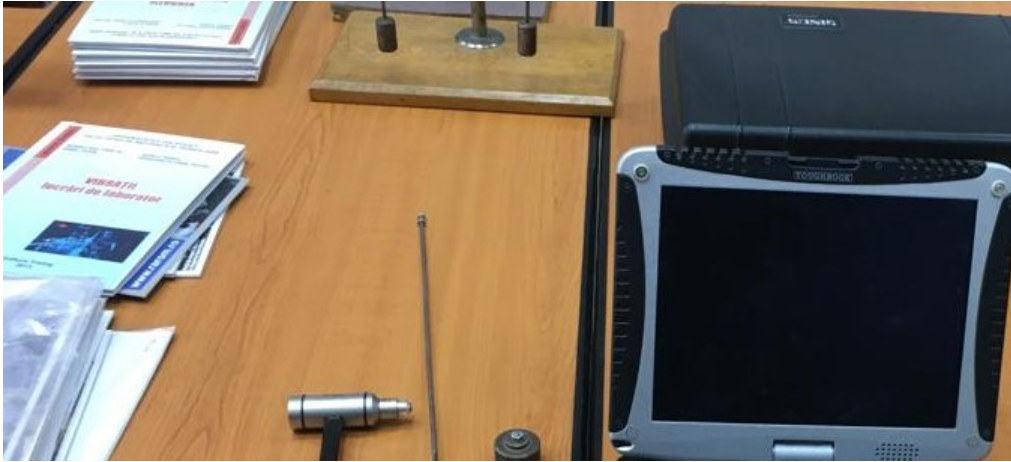
Fig.A.4.8 Laborator Vibrații și zgomote (3) - Sistem de achiziție date SOUNDBOOCK cu soft SAMURAI pentru măsurarea și analiza vibrațiilor și zgomotelor.
