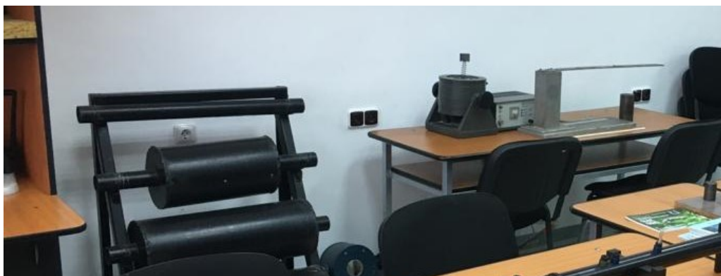
Fig.A.4.7 Laborator Vibrații și zgomote (2) - Aparatură pentru măsurarea coeficientului de absorbție acustică (tub acustic)
