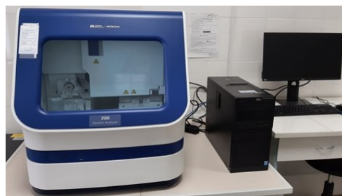
Генетический анализатор 3500xL Applied Biosistem
